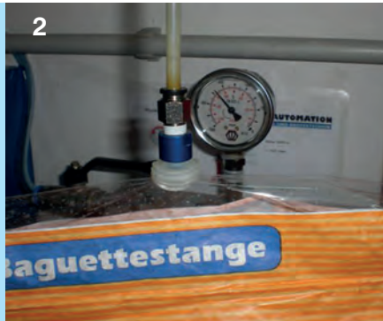
2 Mit Cellophan verpackte Lebensmittel. Lösung: Balgensaugern Art.Nr. 01 30 32/ 01 40 42 (S. 1.46) mit Filtersieb (siehe Bild 15 und Vakuum-News auf www.mf-automation.com ) Food packed with Cellophan. Solution: Bellows Cups Art.No. 01 30 32 / 01 40 42 (p. 1.46) with gauze filter (see picture 15 and Vacuum News on www.mf-automation.com )
